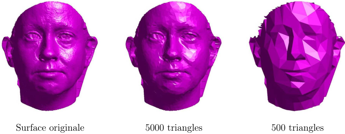
FIG. 6.1 – Comparaison entre une surface triangulée et deux sous-échantillonnages
